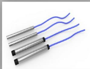
*Los piezómetros de cuerda vibrante miden presión de poro desde el coronamiento, muro y ubicaciones más relevantes dentro de la estructura para monitorear subpresiones, control de deslizamientos y otros.*
