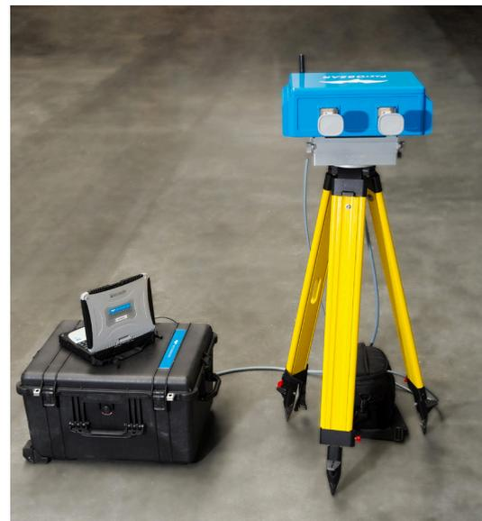
FastGBSAR-R instalado en trípode
